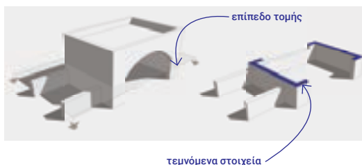
Εικόνα 3.1 Επίπεδο τομής για σχέδιο κάτοψης.
