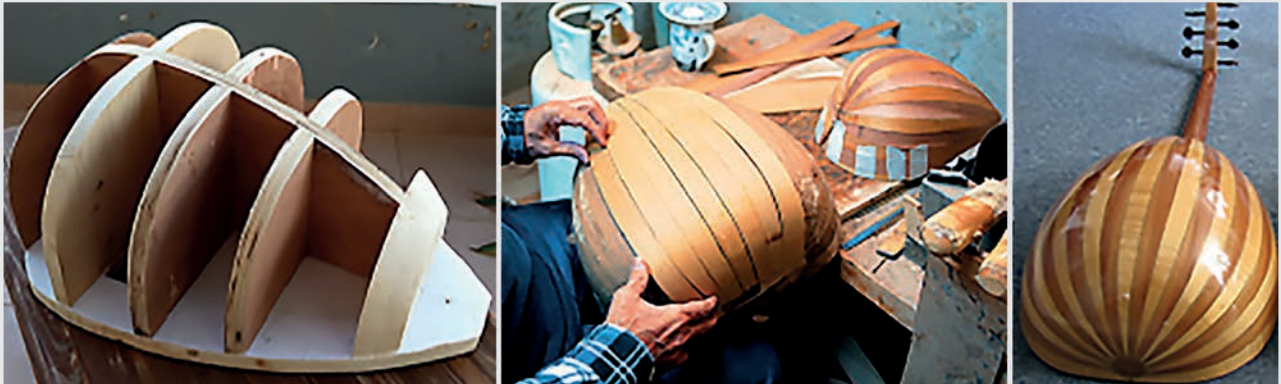
Εικόνα Α.45 Κατασκευή λαούτου με λουρίδες, «ντούγιες» πάνω σε μοντέλα-καλούπια.
