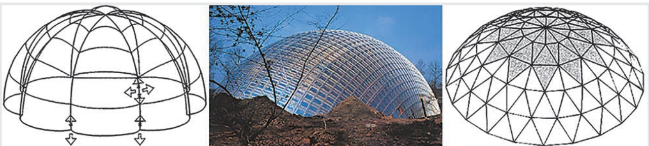
Εικόνα A.43 Κατασκευή τρούλου. Μεσημβρινοί και παράλληλοι, το ημισφαίριο «ξάπλωμένο» στο πλάι με τους παράλληλους να είναι κάθετοι προς το έδαφος και ημισφαίριο με παράλληλους και διαγώνιες συνδέσεις που διαμορφώνονται με τρίγωνα.
