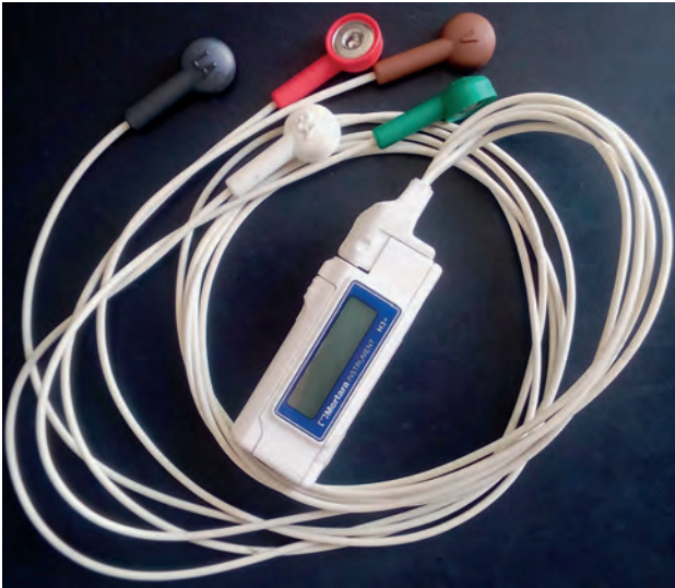
Εικόνα 2.8. Συσκευή Holter συνεχούς καταγραφής του ΗΚΓ, σε 24ωρη ή 48ωρη διάρκεια. Η συσκευή συνδέεται με 5 ηλεκτρόδια patch, τα οποία προσκολλώνται επιμελώς στο δέρμα του κατώτερου τμήματος της πρόσθιας επιφάνειας του θώρακα, μετά από επιμελή καθαρισμό του. Η αξιολόγηση των ευρημάτων του Holter γίνεται από τον υπεύθυνο καρδιολόγο.
