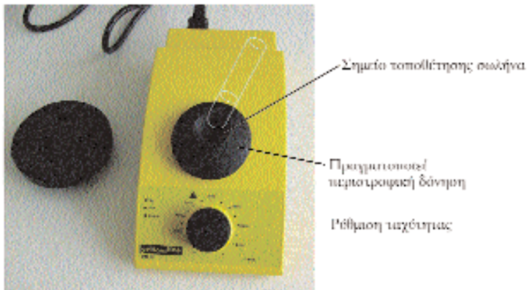
Εικόνα 3. Αναδευτήρας τύπου Vortex. Είναι κατάλληλος για μικρά σκεύη όπως δοκιμαστικοί σωλήνες. Πραγματοποιεί περιστροφική δόνηση είτε συνεχώς είτε κατά την πίεση του σκεύους πάνω στην ειδική υποδοχή.
