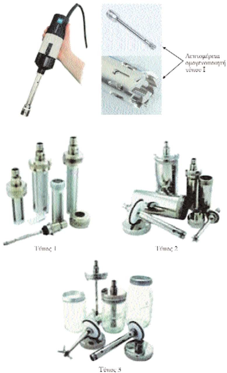
Εικόνα 6. Τύποι ομογενοποιητών με μαχίρια.
