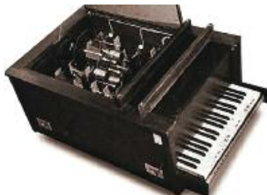
Σχήμα 1.7 Orthophonic Piano, Rossine (1916). Οπτοφωνικό πιάνο που διέθετε γυάλινους ζωγραφισμένους δίσκους, απ' όπου περνούσε φως, όταν ο μουσικός πίεζε τα πλήκτρα παίζοντας μουσική, ενώ ταυτόχρονα το φως προβαλλόταν στον χώρο (πηγή: www.obsolete.com/120 years ).
